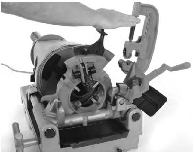
Figura 19 – Cierre del cabezal de terrajas con retroceso
