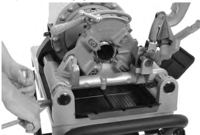
Figure 24 – Filetage des tuyaux (ici, à l'aide d'une tête de filière à ouverture rapide 811-A)
