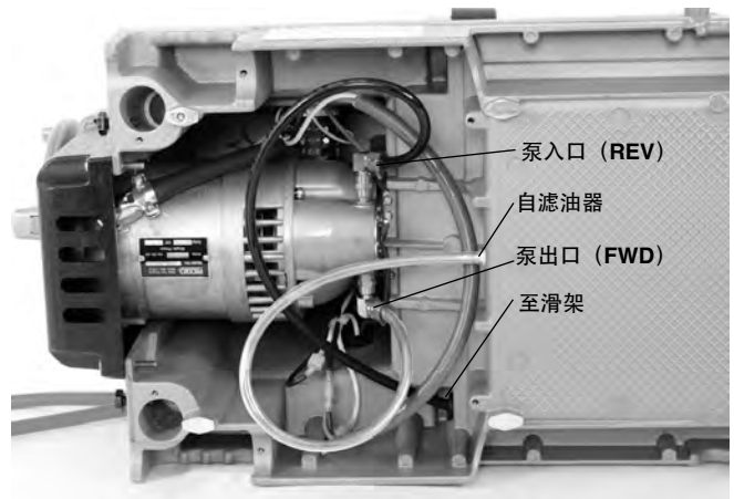
图25B – 右手套丝油泵接口 (开关处于FWD位)
