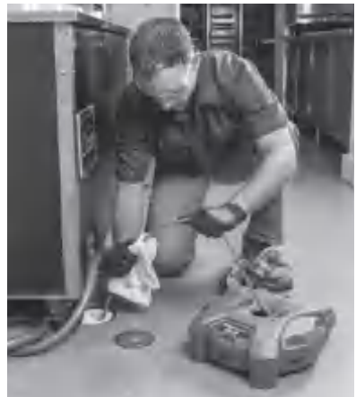
图 15-向钢索护套管涂抹润滑剂
