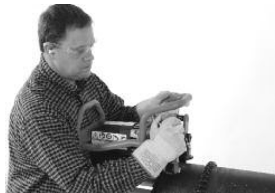
图 10A 用手紧固夹紧螺丝
