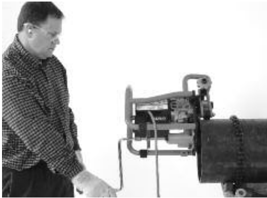
图15A 坡口操作
