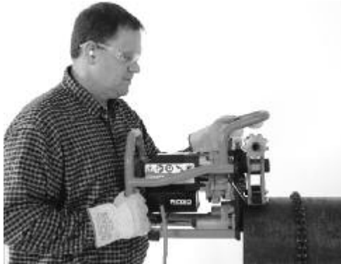
图8A 将坡口机放在管道上
