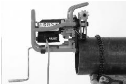
图11 安装在工件上的坡口机
