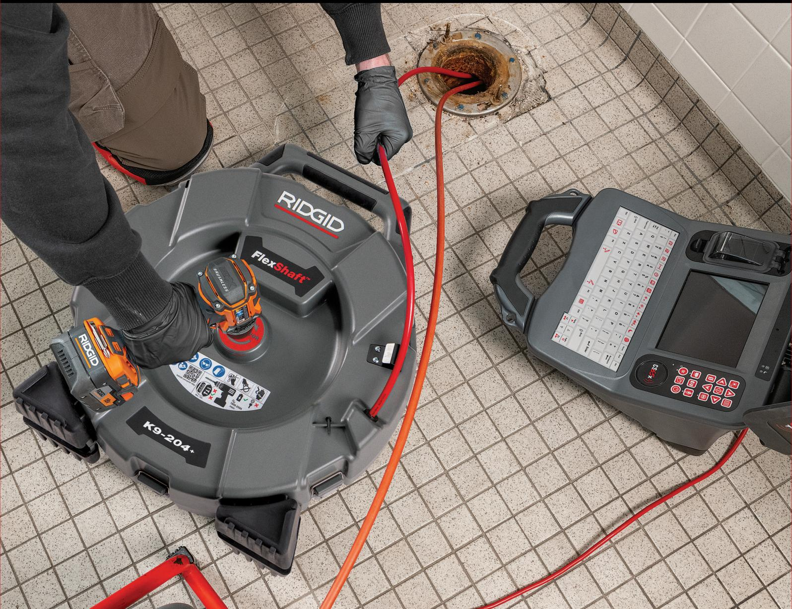
RIDGID® FlexShaft™系列管道疏通机重量轻、结构紧凑且高效，适用于对 1¼" - 4" (32-100mm) 的管道进行管内壁整体清洁，长度最大为 70' (21.3m)。K9-204+ 管道疏通机还可以在工作时搭载摄像头，让您实时查看清洁情况。该升级版本外部采用搭扣设计，方便操作人员快速打开并进行维护。此外，升级版还配备了改良的钢索夹用于增加钢索保护，且配备了存放六角扳手的空间。
