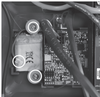
图 23 - 断开电池连接并拆下螺钉
