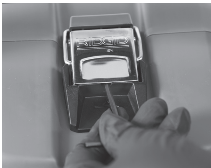
图 16 — 打开提手下方的门锁（使用内六角扳手）
