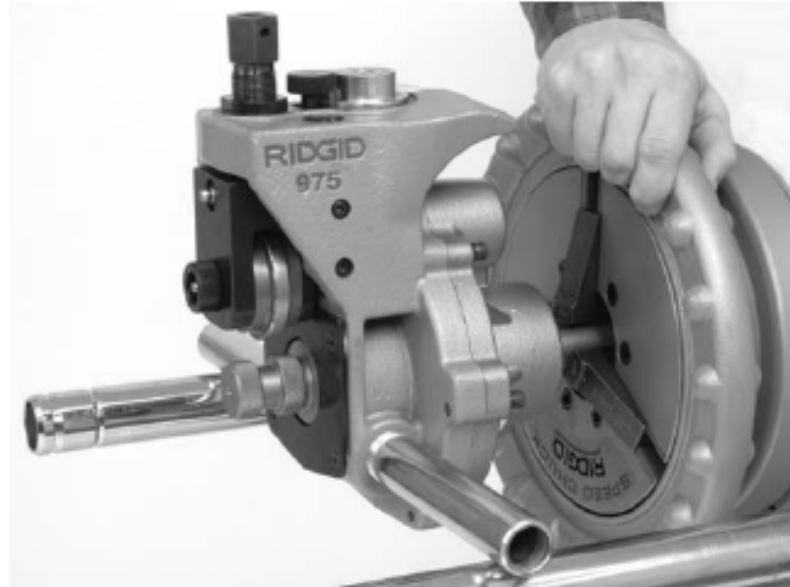
图3 — 安装975型滚沟机于300型动力驱动机上
