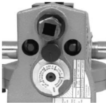
图 7A — 正确的滚沟深度参数位于调节螺母正下方
