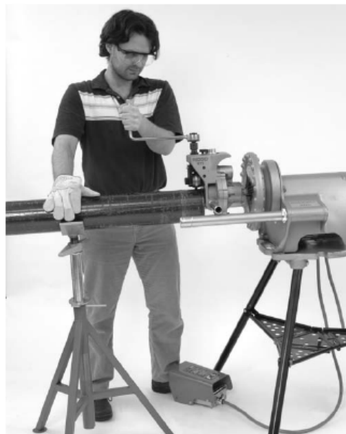
图10 — 滚沟是为了防止走偏，施加力给管子
