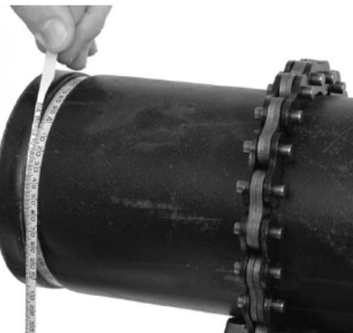
图 8 — 用直径测量尺测量滚沟直径尺寸
