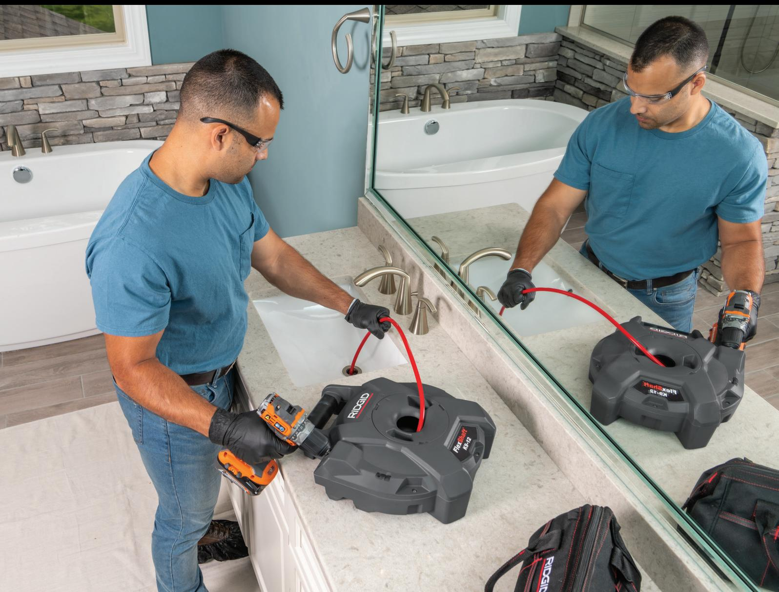
全新 RIDGID® FlexShaft K9-12 是 FlexShaft 系列管道疏通机中结构较为紧凑的一款。它采用了全封闭式外壳，内有长 30' (9m) 且封装在尼龙护套中的 FlexShaft 钢索，便于整理和清洁。产品轻巧，便携，非常适合用于疏通 1¼" -2" (32mm-50mm) 的管道。
