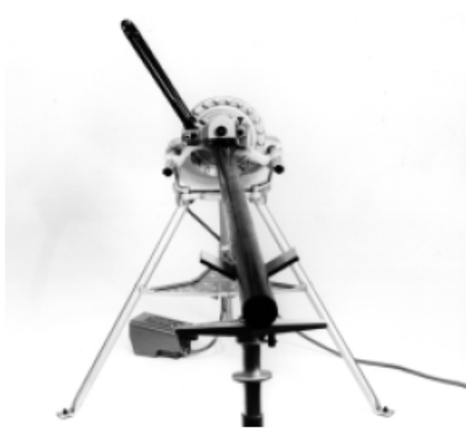
图8B — 机器正向转动偏离 1/2 度
